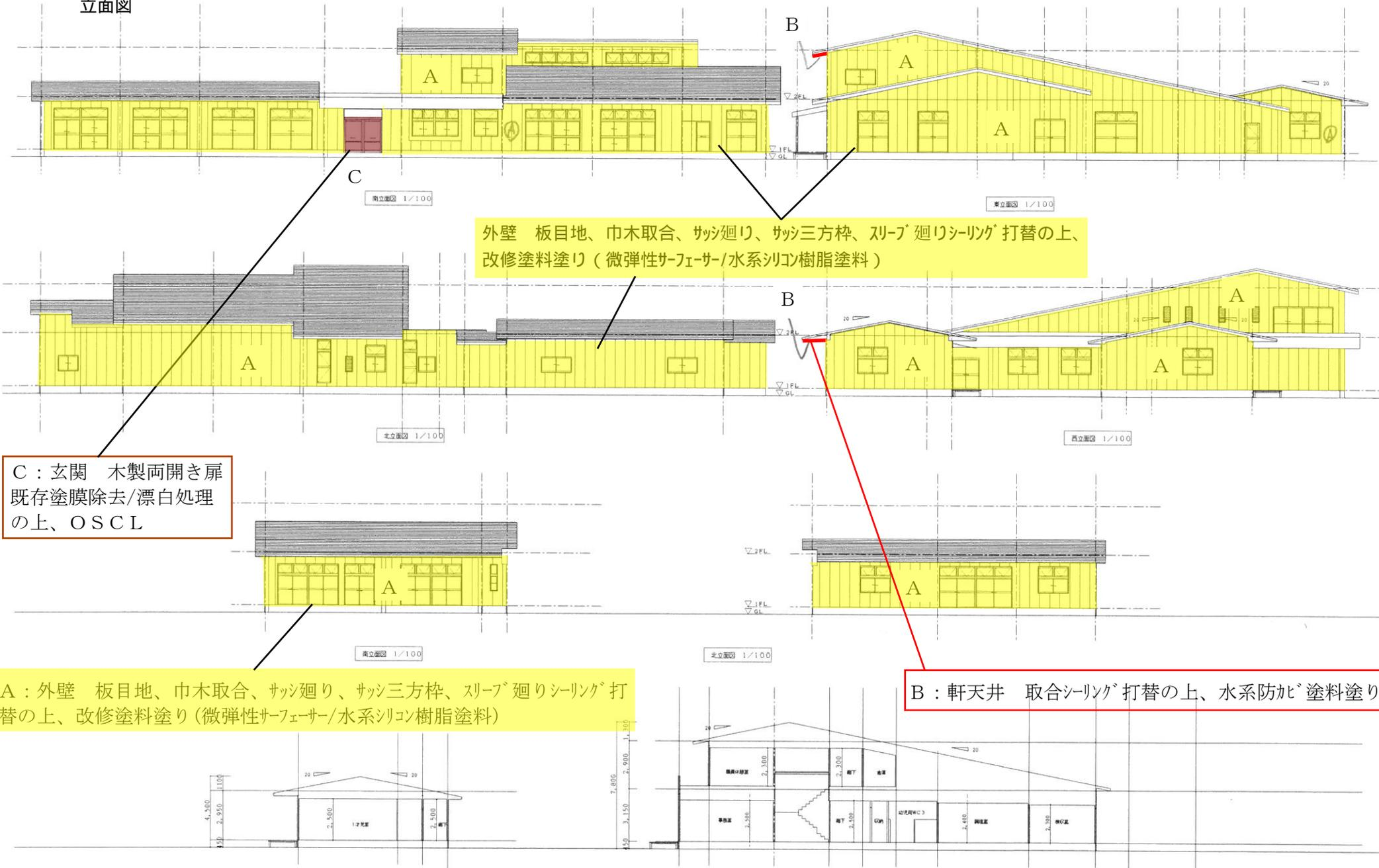
外壁 板目地、巾木取合、サッシ廻り、サッシ三方枠、スリーブ廻りシーリング 打替の上、改修塗料塗り（微弾性サフェーサー/水系シリコン樹脂塗料）
